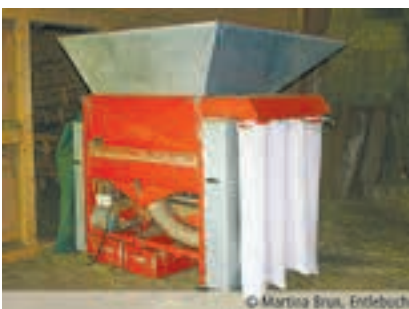
Die Heureinigungsmaschine hat die Funktion, im Dürrfutter Staub und Erde zu entfernen.
