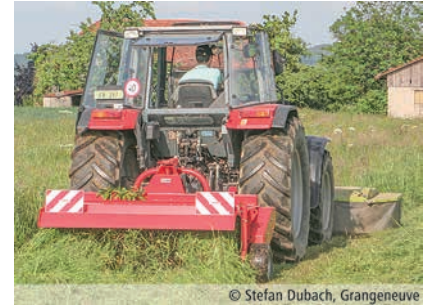
Der Mähauflbereiter fördert die schnelle Trocknung des Futters und vermindert die Verluste.
