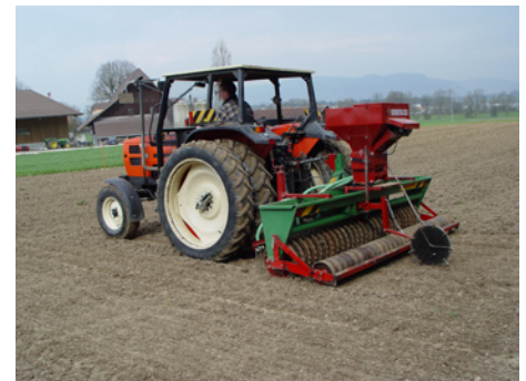
Neuansaat mit einer Cambridge-Säwalze
