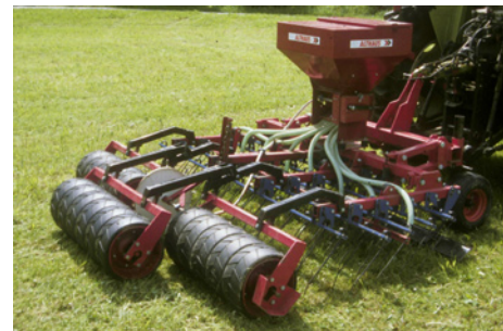
Übersaat mit einem Sästriegel
