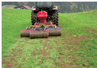
In presenza di mucchietti di terra, la combinazione erpice-seminatrice, seguita da una rullatura, assicura un buon contatto tra semente e terreno. Questa variante non è adatta se la cotica è infeltrita.
